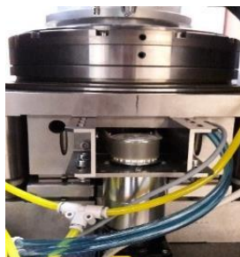
Программно-управляемый электрошпиндель вертикального исполнения на аэростатических опорах
