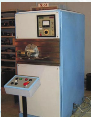
Магнитоимпульсный пресс (МИП 20)
