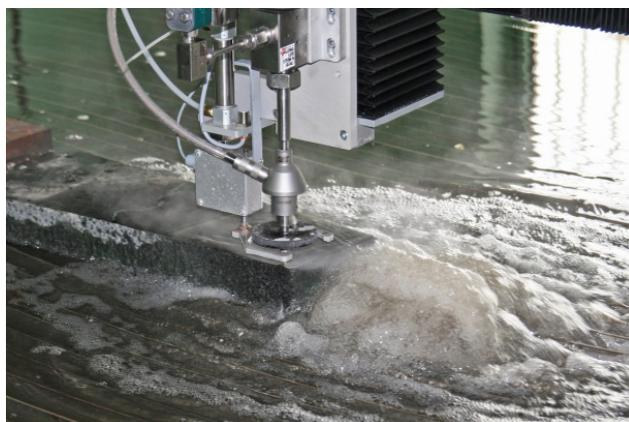
Автоматизированный комплекс гидроабразивного раскроя листовых материалов
