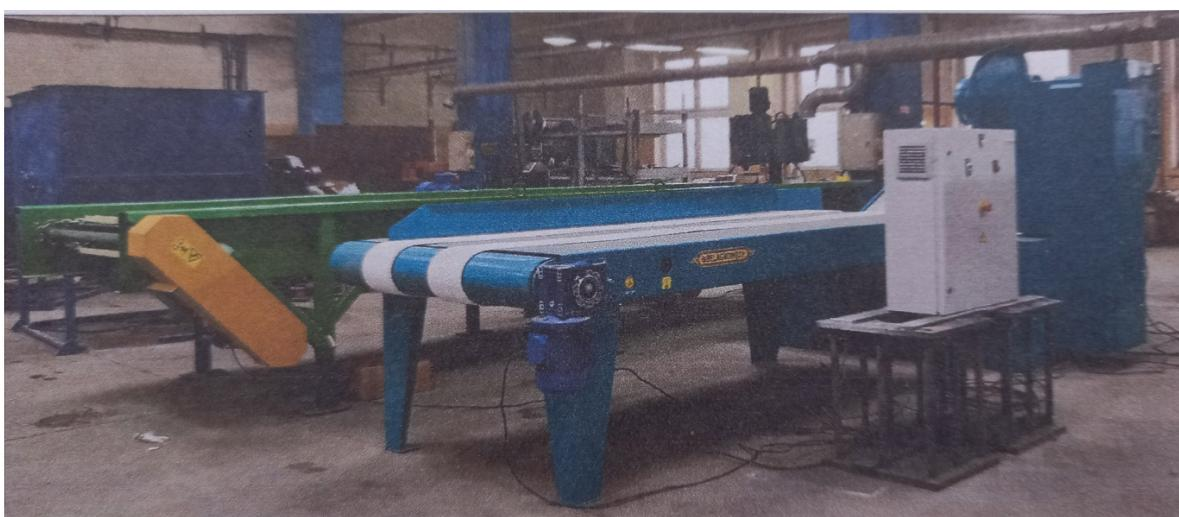
**Описание импортозамещающей продукции:** линия предназначена для аккумуляции партии рулонов тресты на определенное время работы, механизированной их размотки с отбором прокладочного шпагата и передачи ленты тресты в последующую переработку.
