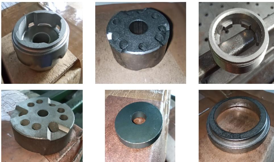
**Описание импортозамещающей продукции:** детали амортизаторов из порошкового материала на основе железа: направляющая 11.2905618-30 (заготовка), поршень 11.2905634-50, гайка 40.УЛИГ.452995.398, поршень 45.2905634 (заготовка), тарелка ограничительная 11.2905628-30, втулка 50.2905602-20-01. Высокая точность изготовления рабочего контура детали не требует дополнительной механической доработки. Стабильные характеристики выпускаемых изделий. Нет аналогов в республике.
