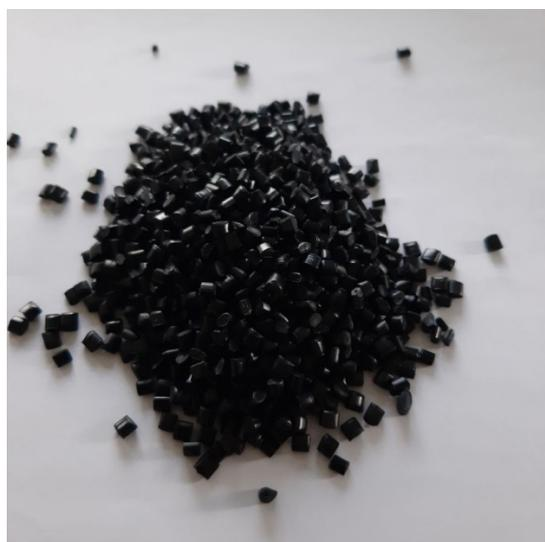
**Описание импортозамещающей продукции:** используется для переработки, предпочтительно литьем под давлением, и изготовления этим методом элементов пластиковых лыж – носка и пятки.
