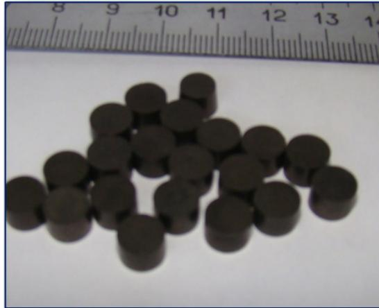
**Описание импортозамещающей продукции:** предназначены для обработки труднообрабатываемых материалов (каленные стали, чугуны и т. п.).
