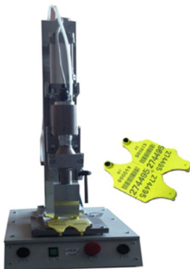
**Описание импортозамещающей продукции:** предназначено для ультразвуковой сварки изделий из полимерных материалов при производстве ушных бирок для маркировки крупного рогатого скота и других сельскохозяйственных животных.
