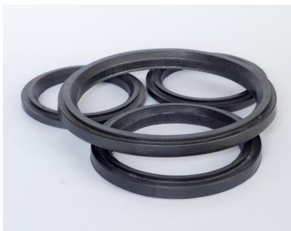
**Описание импортозамещающей продукции:** предназначены для использования в шаровых кранах магистральных трубопроводов. Изготавливаются из термоэластопластов и перерабатываются высокопроизводительным методом литья под давлением. Обладают низким коэффициентом трения (близким к материалам на основе фторопласта-4) и усилием стягивания, повышенной нагрузочной способностью. Не подвержены хладотекучести под нагрузкой, свойственной фторопласту.
