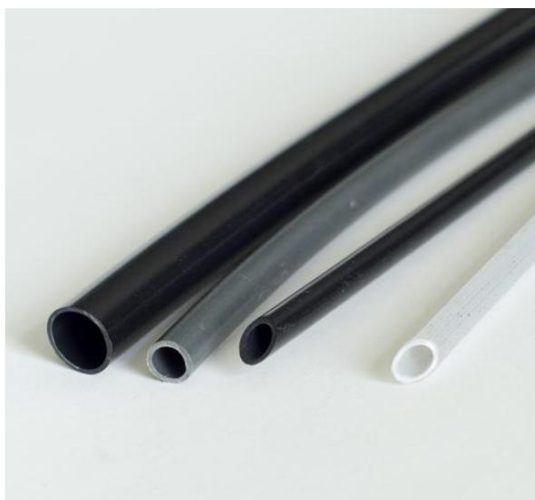
**Описание импортозамещающей продукции:** предназначены для использования в качестве гибких трубопроводов в пневматических тормозных системах тракторов и автомобилей. Изготавливаются методом непрерывной шнековой экструзии из экструзионного ударопрочного материала марки «Этаמיד ЭА-ЭУ».
