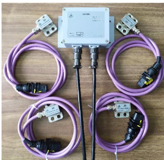
**Описание импортозамещающей продукции:** предназначена для установки на большегрузные автомобили с рессорной подвеской с целью контроля общего веса нагрузки автомобиля, ее распределения по осям автомобиля и разницы в нагрузках левой и правой полуосей, а также контроля температуры в месте установки моста, что позволяет снизить количество преждевременных поломок или износа автомобиля, вызванных перегрузом.
