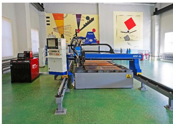
Автоматизированные 5-координатные комплексы плазменного раскроя листовых материалов
