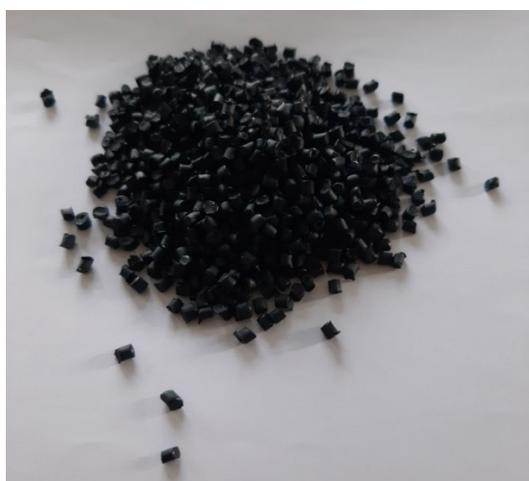
**Описание импортозамещающей продукции:** предназначен для изготовления изделий технического и бытового назначения, эксплуатирующихся в условиях повышенных динамических, в том числе ударных нагрузок, а также в узлах трения без смазки или при ее ограничении, маслобензостойких трубопроводов, емкостей для хранения нефтепродуктов и органических растворителей.
