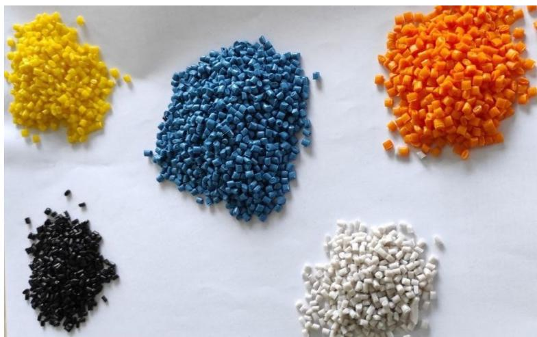
**Описание импортозамещающей продукции:** термопластичный конструкционный материал. Предназначен для изготовления конструкционных деталей автотракторной техники (рулевые колеса и др.), эксплуатирующихся в интервале температур от  $-40^{\circ}\text{C}$  до  $+110^{\circ}\text{C}$ .
