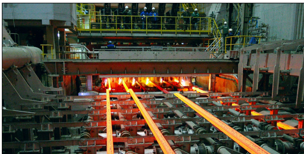
Промежуточный этап новой технологии (стадия прокатки круглого прутка)
